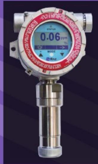
RAEGuard 2 PID 是一款具有隔爆型主机和本安型光离子智能传感器、固定安装方式的有机气体检测仪。仪器采用了智能化处理平台和数字化传感器技术，实现了传感器离线标定和环境适应功能，还可根据用户要求定制不同量程。在外部功能上，检测仪具有图文显示和本地声光状态指示等功能，同时，检测仪采用三键磁棒外部调节的方式，使操作人员在现场无需开盖，即可方便的进行标定和维护。
